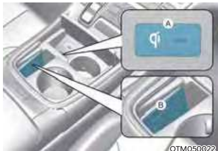
[A]: Kontrolka, [B]: Nabíjecí podložka
