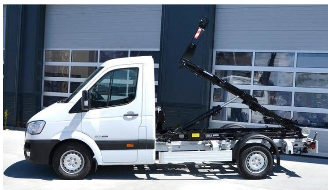
Detail rámové konstrukce a zdvihacího pístu
