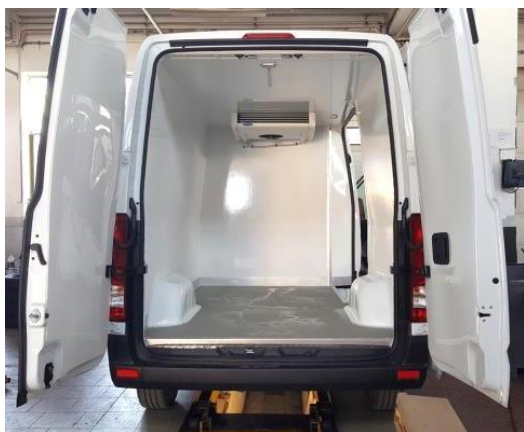
Protiskluzová podlaha s hliníkovými ochrannými lištami
