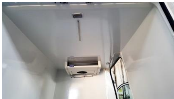
Detail stropu s integrovaným světlem a chladícím agregátem
