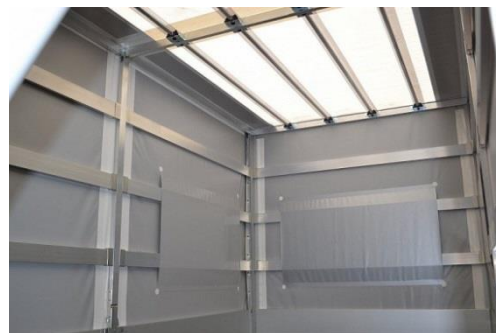
Celní, nedělená plachta z materiálu Mehler, na bocích kapsy proti nadouvání
