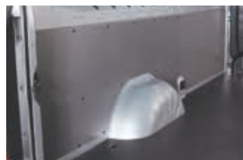
Kryty bočních stěn (dřevovláknitá deska)
