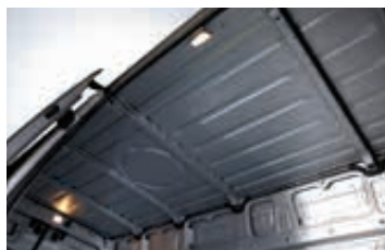
Osvětlení nákladového prostoru
